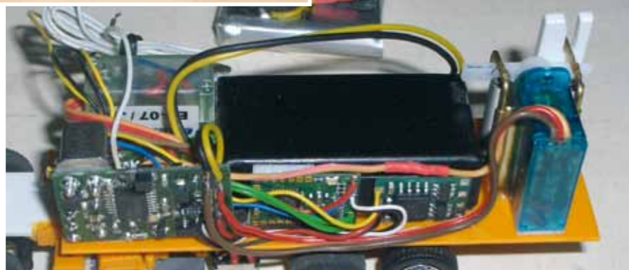
Das Soundmodul und die Lautsprecheranlage fanden in der Mitte ihren Platz. Die Platine wurde im Bereich der Anschlüsse etwas gekürzt, um Platz zu sparen
