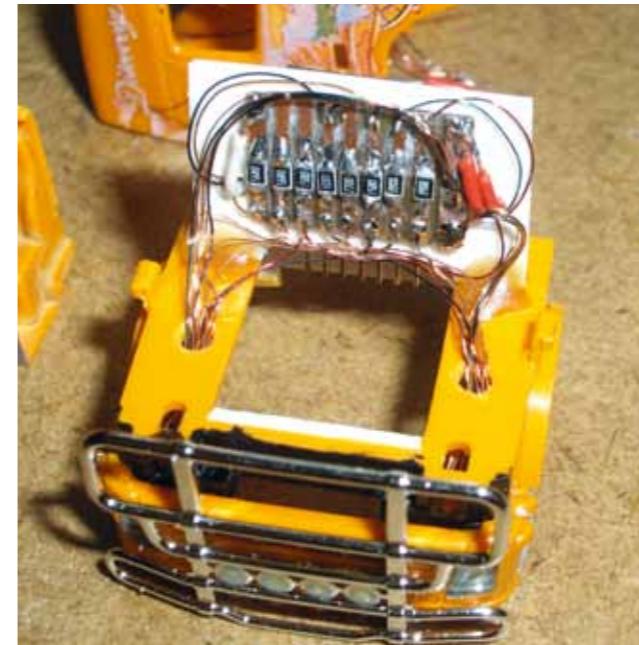
Auf der Verteilerplatine mit den aufgelöteten Vorwiderständen für die einzelnen Leuchten fand jedes Kabel seinen vorgesehenen Platz
