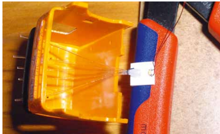
Ein Blick unter das Fahrerhausdach zeigt die Lichtleiterkonstruktion für die kleinen Leuchten über der Windschutzscheibe
